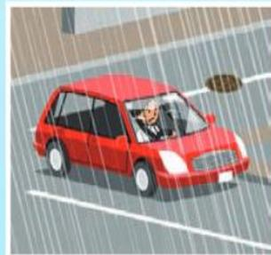
高速走行時、車輪と路面の間に水膜が生じブレーキが効かなくなる。(ハイドロプレーニング現象)
