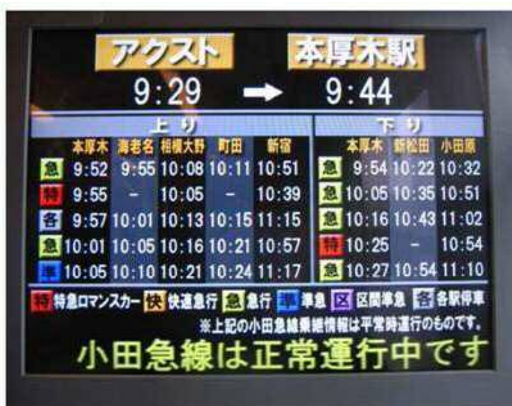
図 連節バス車内に設置したバスと鉄道(小田急線)の運行情報提供システム画面
