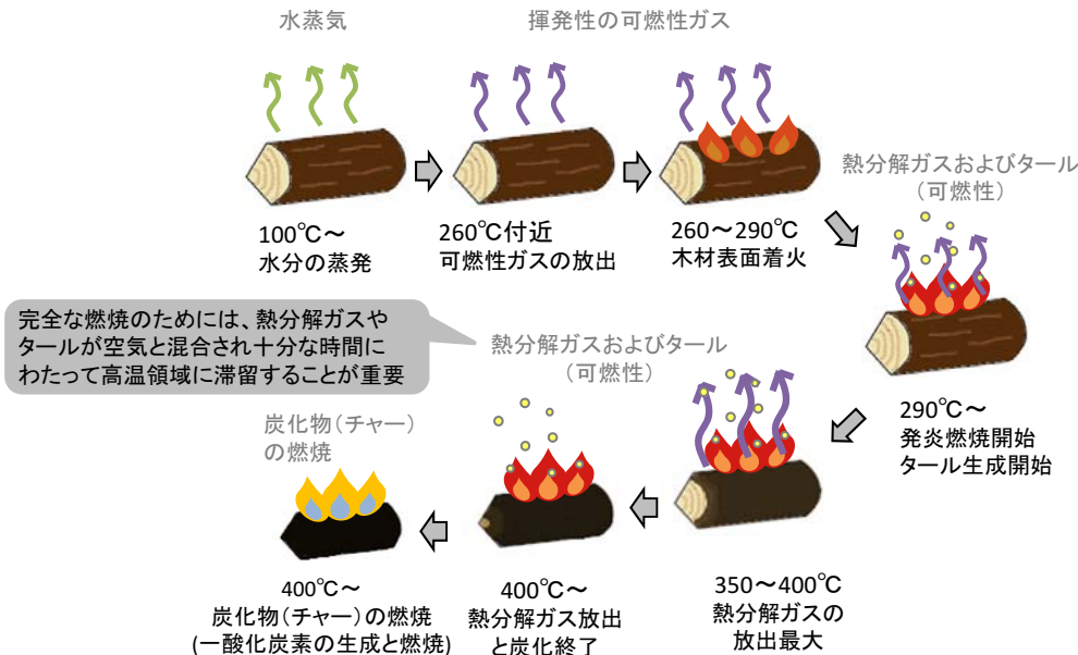
図 2-4 木材の燃焼プロセス
